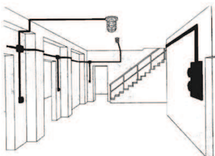
Esempio di posa in tubo a vista.
